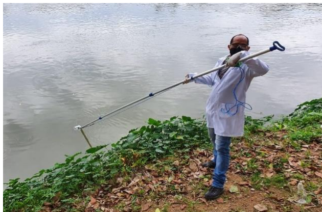
Figura 10 – Teste de campo com a sonda multiparamétrica.
