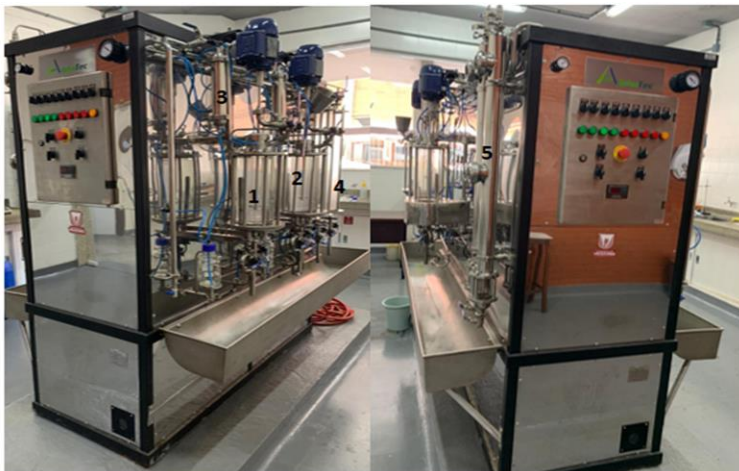
Figura 1- Unidade piloto localizada na Universidade de Vassouras-RJ. (1) Reator vertical de tratamento de matéria prima; (2) Reator vertical de transesterificação; (3) Flash; (4) Decantador; (5) Coluna de adsorção.
