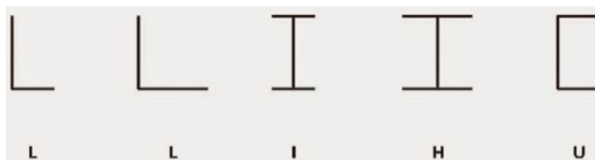
Figura 2 - Formato de perfis de aço laminados.
