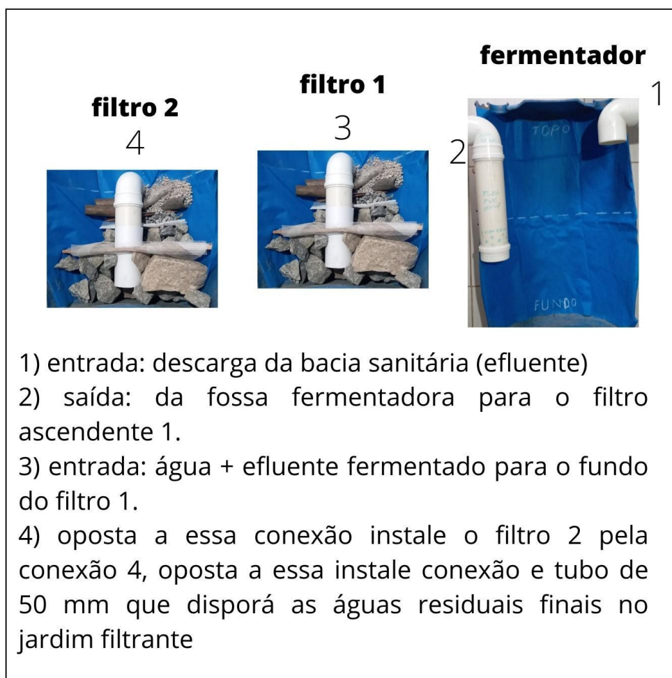
Figura 1 - Esquema da Fossa Fermentadora com o fermentador e dois filtros
