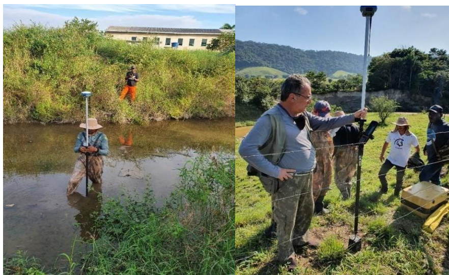
Figura 2 – Levantamento topobatimétrico das seções de rios a partir do RTK e marcos auxiliares instalados para levantamento do Rio Capivari
