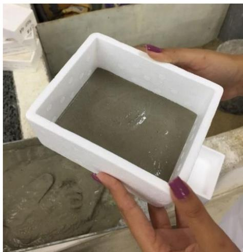
**Figura 4** – Moldagem das placas
