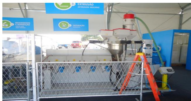
**Figura 1.** Máquina extrusora que utiliza calor e pressão para transformar a PET picada e os adjuntos em um novo polímero.
