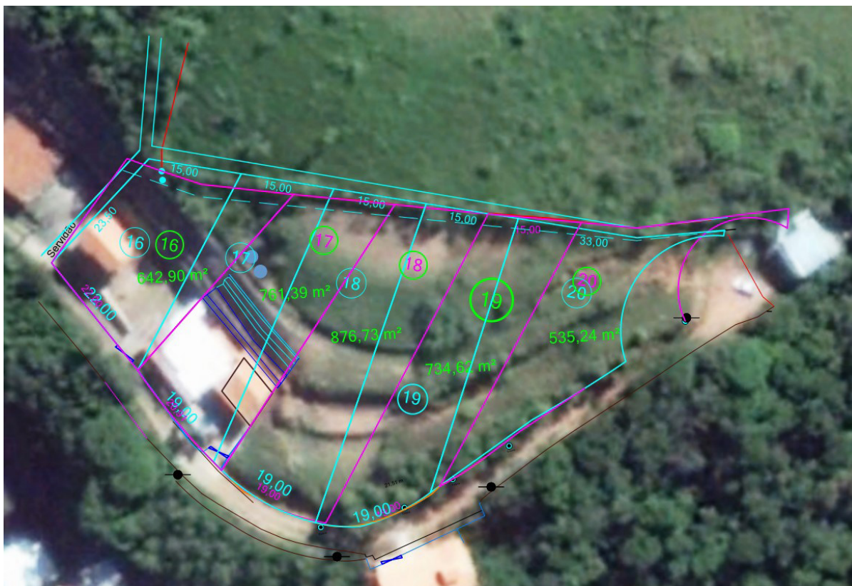
Figura 4. Ocupação em desacordo com o projeto aprovado para condomínio de lotes no Município de Miguel Pereira, RJ.
