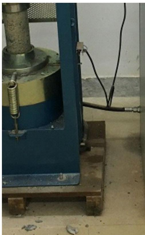
Figura 2: Ensaio de compressão axial do concreto na prensa hidráulica. Autoria própria.
