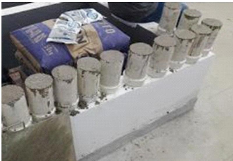
Figura 2: Corpos de prova cilíndricos durante a moldagem. Autoria própria.
