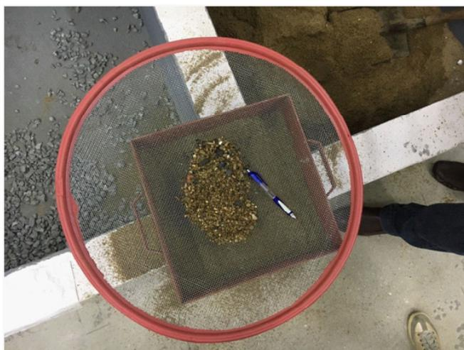
Figura 1: RCD após coleta e fragmentação, passando pelo peneiramento. Autoria própria.
